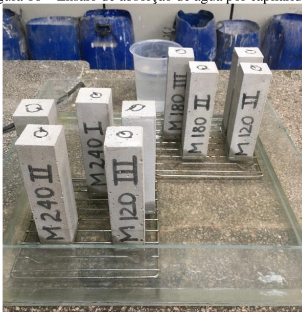
Figura 16 – Ensaio de absorção de água por capilaridade.
