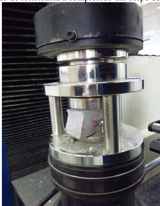
Figura 17 – Ensaio de resistência à compressão em corpo de prova prismático.
