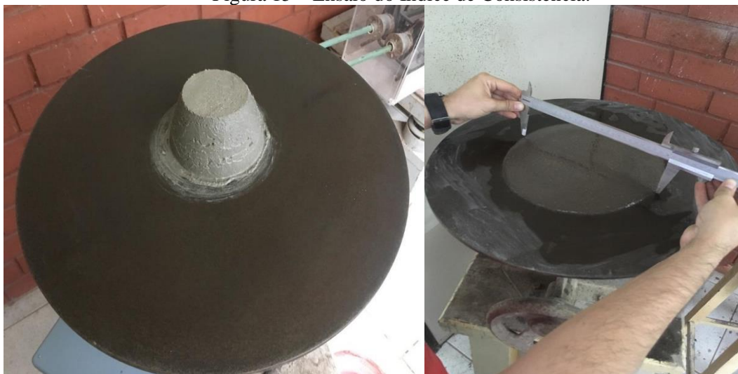
Figura 15 – Ensaio do Índice de Consistência.
